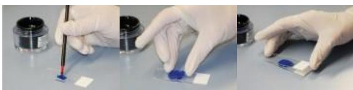
3. スライドガラスに転写サンプルを固定する為に、少量のテクノビット 2220 をスライドガラスにのせ、その上に転写サンプルを載せてください(注意: 転写面をかならず上にして下さい)。もう一枚のスライドガラスを転写サンプルの上に載せて、しっかりとはさみこみます。その後ブルーライトを照射して、転写サンプルをスライドガラスに接着します。
