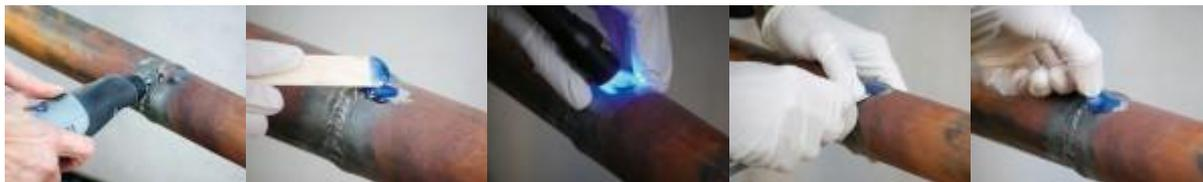
1. 転写したい場所のグラインディング、ポリッシング、エッチングを行ってから、テクノビット 2220 を塗ります。フویلをかぶせて、テクノビット 2220 を薄くのばし、フویلの上からブルーライトを照射します。
