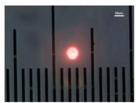
赤色 LED により測定場所を高精度で設定。 (ニコン製顕微鏡に 10×対物レンズを搭載して撮影) ※スポットサイズは対物レンズ、顕微鏡の種類により異なります。
